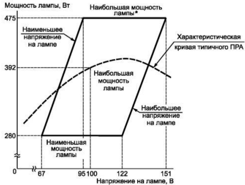
\* Для номинальных питающих напряжений в диапазоне от 220 до 250 В наибольшая мощность ламп не должна превышать расчетную более чем на 20 %.
