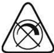
Рисунок 1 - Символ, обозначающий, что затемнение не допускается
