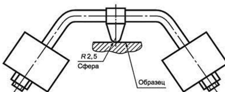
Рисунок 5 - Устройство для вдавливания шарика (по МЭК 60598-1, рисунок 10)
